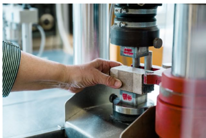
Ein gebrannte Test-Ziegel aus Zement mit Ton wird einer Druckprüfung unterzogen. Foto: Henry Sowinski
