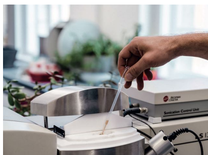
Mit Hilfe eines Lasers wird an der Bauhaus-Universität die Größe einzelner Tonpartikel gemessen. Foto: Henry Sowinski
